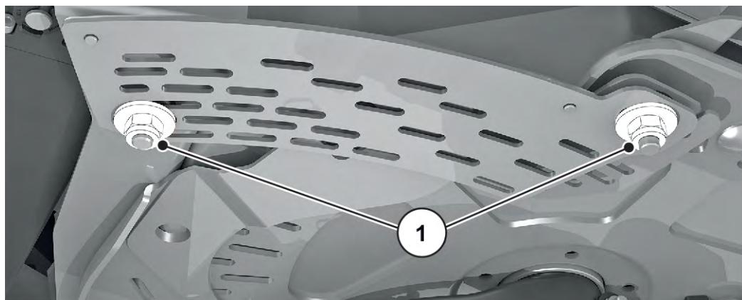
Abb. 96: Befestigungsschrauben der Skala
