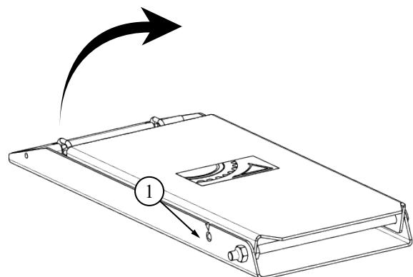
Abb. 50: Unterlegkeil aufklappen
