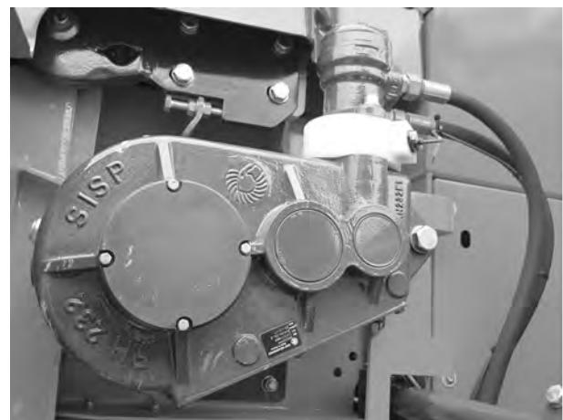
Abb. 71: Motor und Hydraulikblock des Förderband-Antriebs prüfen
