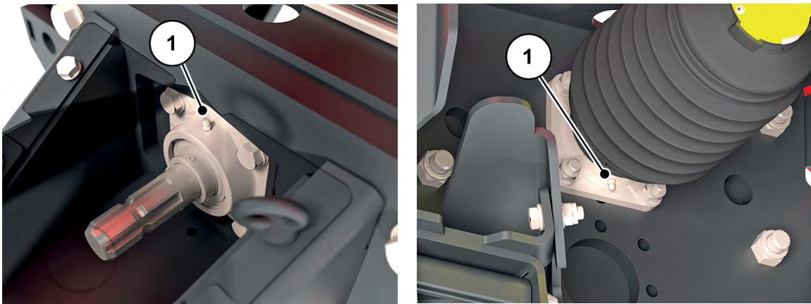
Abb. 63: Schmierstelle Gelenkwellendurchtrieb
