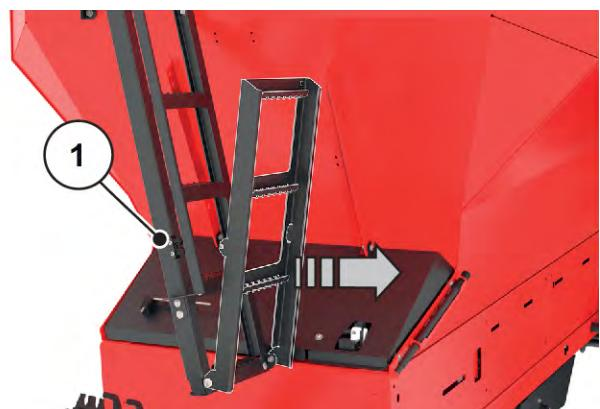
Abb. 35: Leiterunterteil ausklappen
