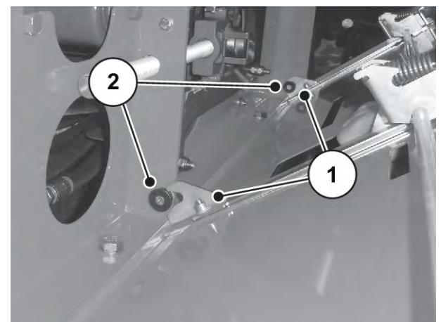
Abb. 57: Seitenabdeckung montieren
