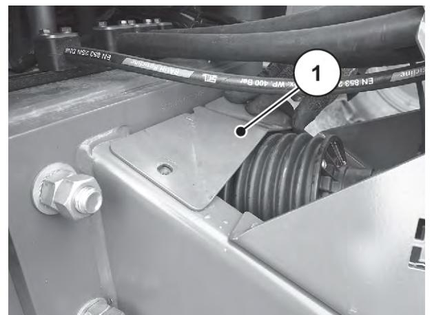
Abb. 21: Schutzblech montieren
