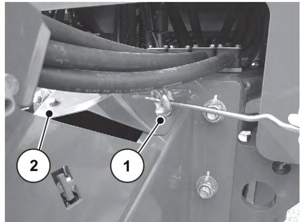
Abb. 18: Schutzblech entfernen
