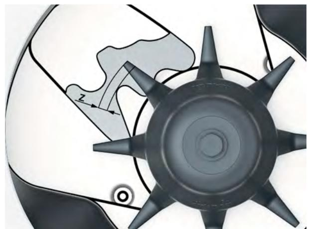
Abb. 94: Verschleißbereich des Rührkopfs
