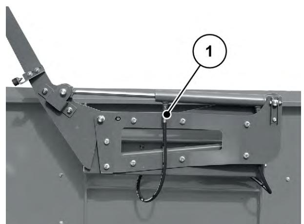
Abb. 70: Hydraulikzylinder Abdeckplane
