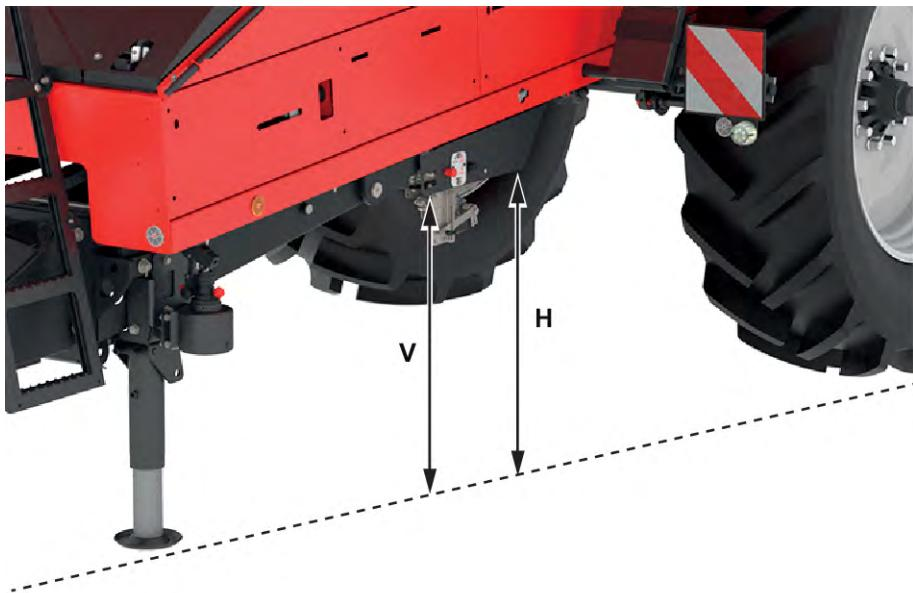
*Abb. 74: Maschinenneigung prüfen*
