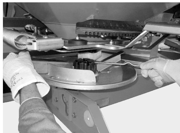
Abb. 42: Hutmutter lösen
