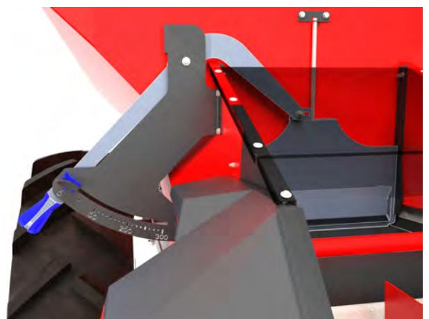
Abb. 33: Vordosierschieber in geschlossener Stellung
