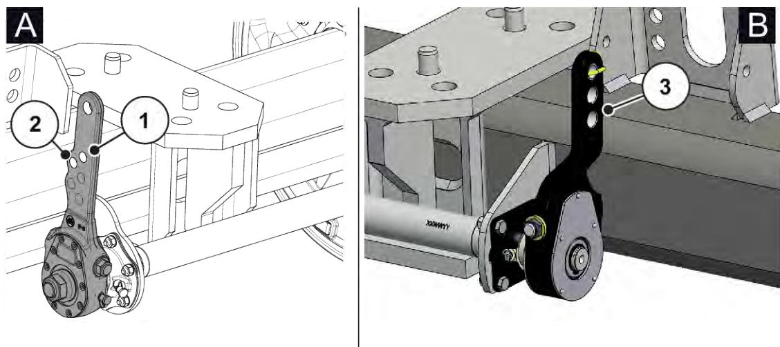
Abb. 89: Position der Verbindung Bremshebel/Bremszylinder - Starrachse
