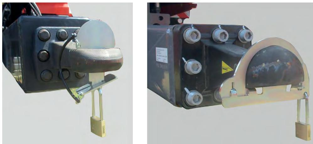
Abb. 14: Sicherung gegen unbefugte Benutzung an Anhängevorrichtungen
