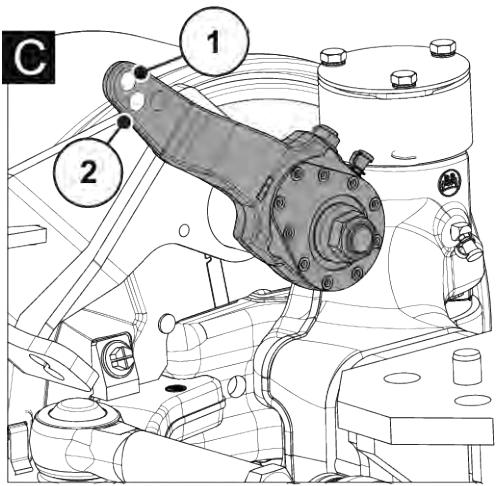
Abb. 90: Position der Verbindung Bremshebel/Bremszylinder - Lenkachse
