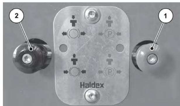
Abb. 32: Feststellbremse lösen
