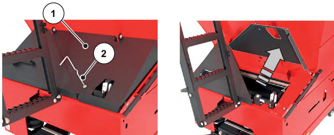
Abb. 67: Vordere Abdeckung öffnen
