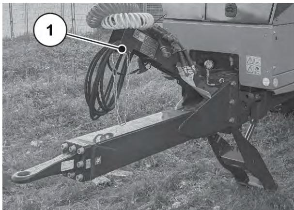
Abb. 53: Gelenkwellenhalterung am Schlauchgalgen
