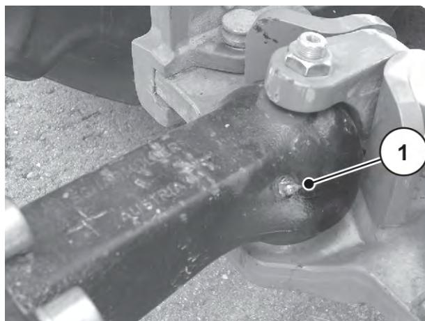
Abb. 60: Kugelkopfkupplung
