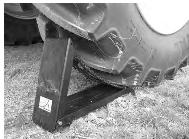
Abb. 51: Unterlegkeil positionieren
