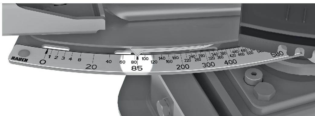
Abb. 45: Skala zur Anzeige der Ausbringmenge
