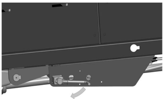
Abb. 31: Manuelle Feststellbremse ist geschlossen
