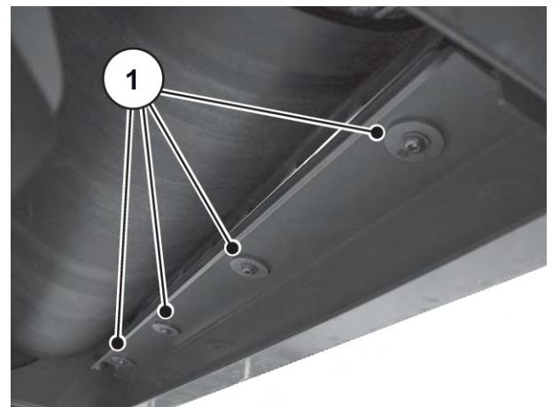
Abb. 83: Position der Halterung anpassen
