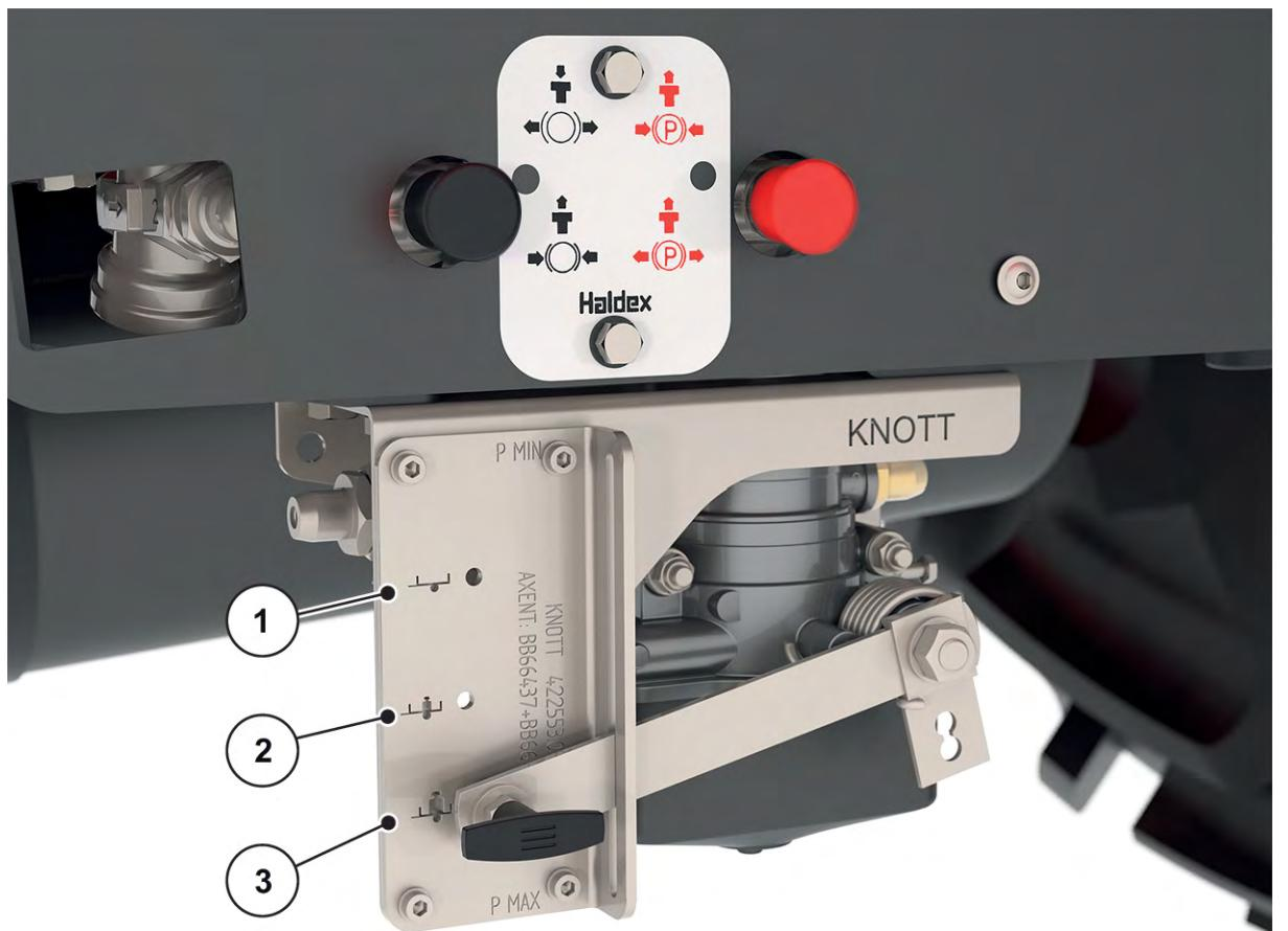
Abb. 30: Einstellung des Bremskraftreglers
