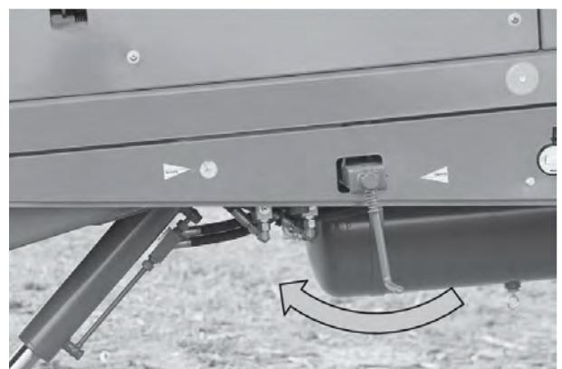
Abb. 49: Feststellbremse (hydraulische Bremsanlage)
