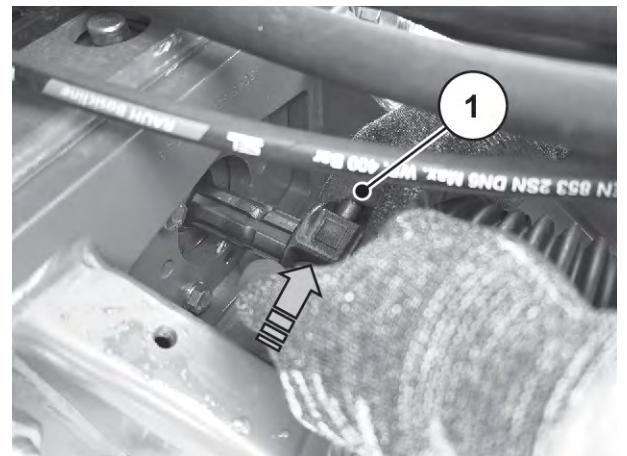
Abb. 20: Gelenkwelle auf Getriebezapfen aufstecken
