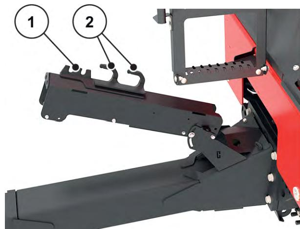
Abb. 54: Ablagekonsole für Kabel, Hydraulikschläuche und Pneumatikleitungen
