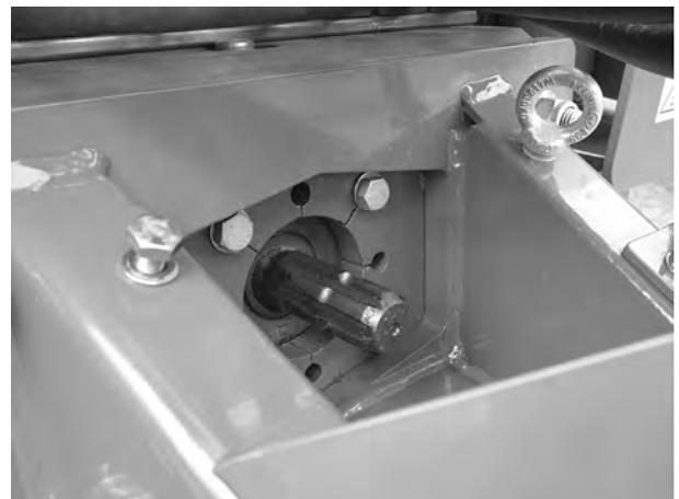
Abb. 19: Getriebezapfen einfetten
