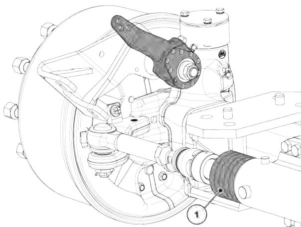
Abb. 72: Distanzscheiben der Lenkachse
