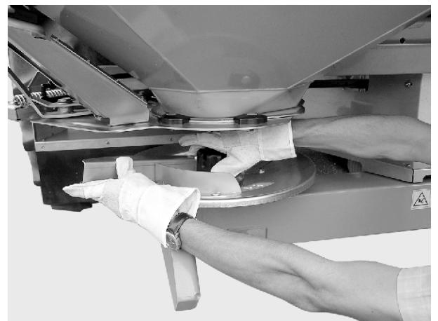
Abb. 43: *Hutmutter abschrauben*
