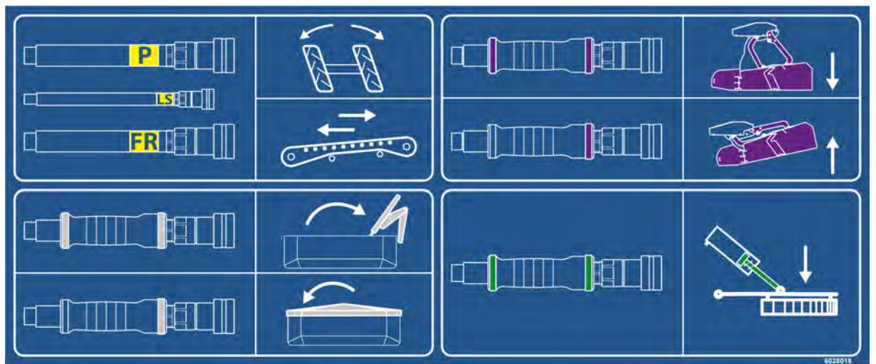
Abb. 25: Kennzeichnung der Hydraulikschläuche Grundmaschine/Sonderausstattungen
