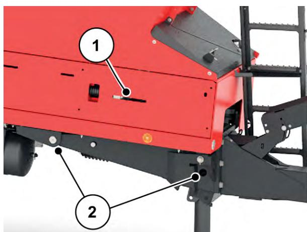
Abb. 61: Schmierstelle Bandantrieb und Deichsel
