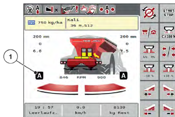
Fig. 52: Affichage du mode d'épandage sur l'écran de travail avec GPS-Control
