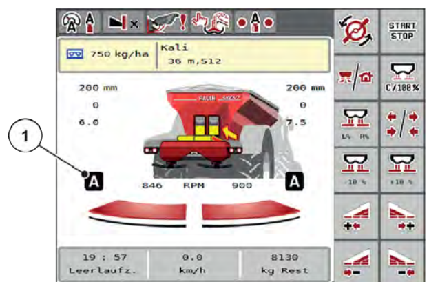
Abb. 52: Anzeige Streubetrieb am Betriebsbild mit GPS Control
