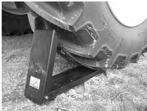
Obr. 82: Polohovanie podkladacieho klinu
