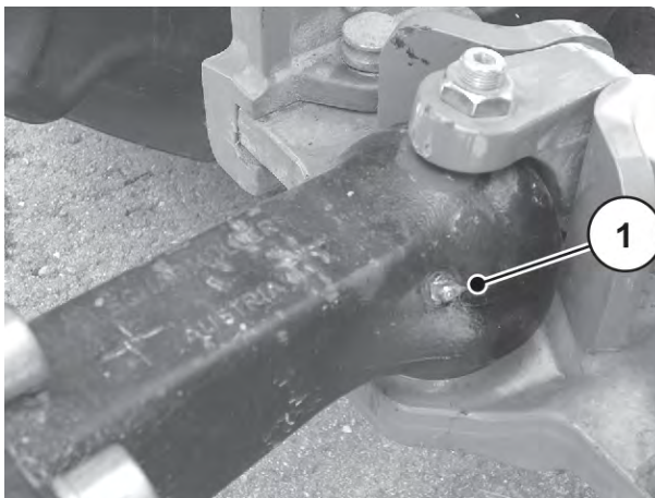
Obr. 93: Spojka s ťažnou guľou
