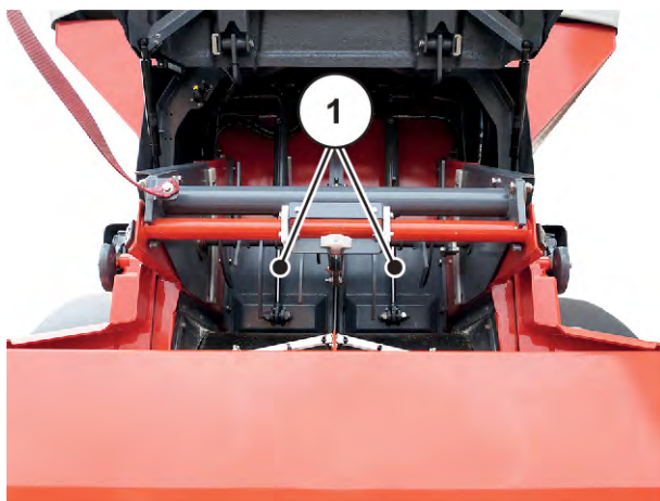
Obr. 52: Posúvač predbežného dávkovania v zatvorenej polohe
