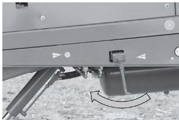
Sl. 84: Povlačenje ručne parkirne kočnice
