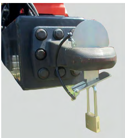
Sl. 12: Zaštita od neovlašćenog korišćenja na priključnim sklopovima
