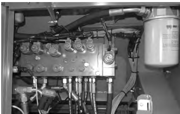
Sl. 107: Upravljački blok
