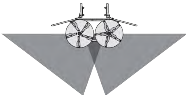
Sl. 75: Normalni opseg rasipanja, tačka za dodavanje materijala u neutralnom položaju
