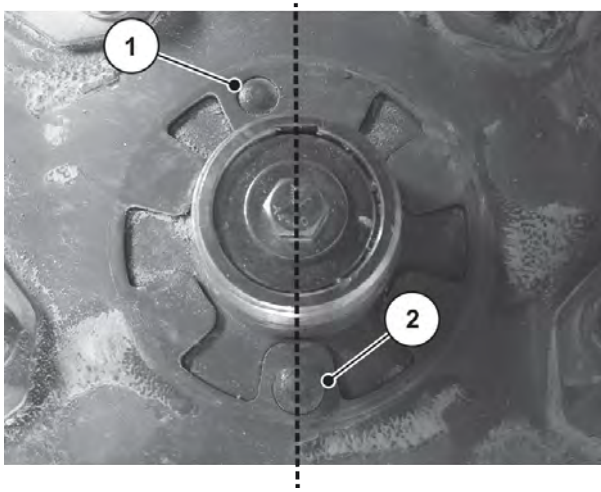
Att. 117: Izkliešanas disku pušu atšķiršana
