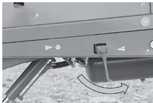
Att. 34: Manuālās stāvbremzes atbrīvošana
