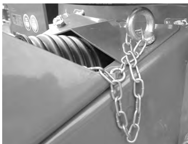
Att. 25: Ķēdes nostiprināšana
