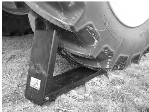
Att. 82: Riteņa atbalsta ķīļa pozicionēšana
