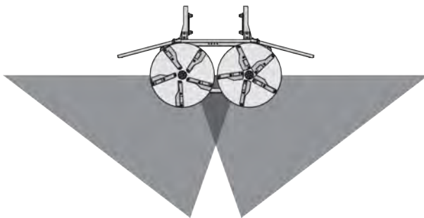
Att. 75: Normāls izkliešanas rezultāts, padeves punkts neitrālā stāvoklī
