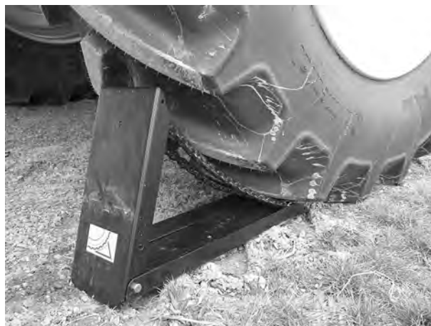
Att. 86: Riteņa atbalsta ķīļa pozicionēšana
