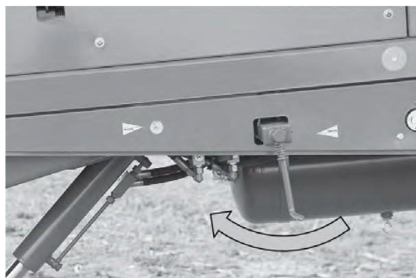
Att. 84: Manuālās stāvbremzes iedarbināšana
