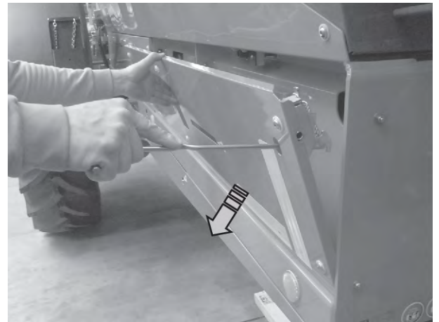
Att. 89: Sānu pārsega atvēršana
