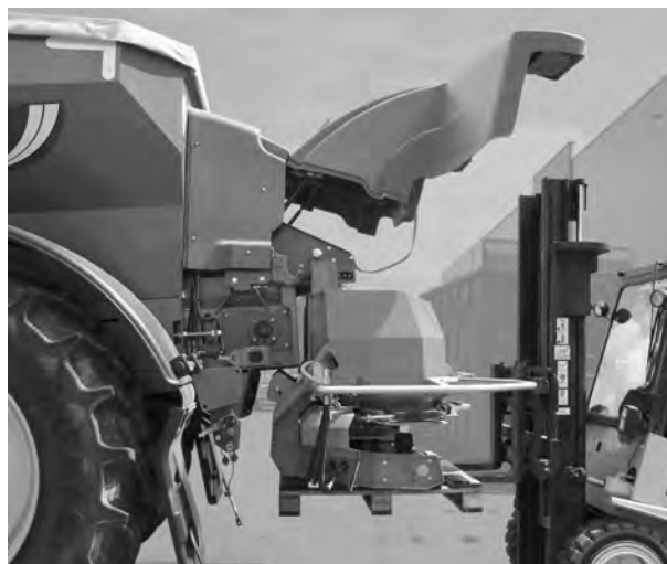
Kuva 46: Haarukkatrukki ajettuna levittimen luo
