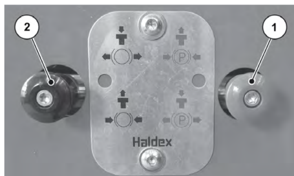
Kuva 80: Manuaalisen seisontajarrun kytkeminen
