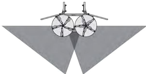
Kuva 75: Normaali hajontakuvio, luovutuspuiste vapaa-asennossa
