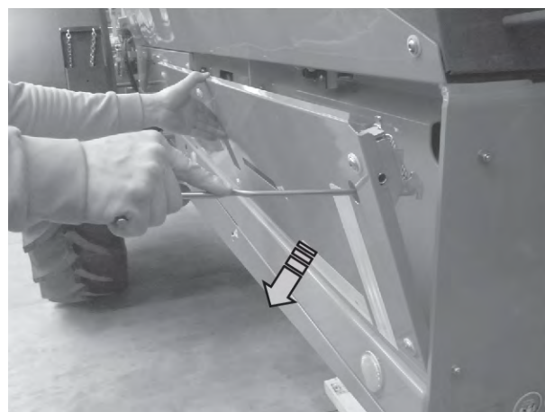
Kuva 89: Sivukannen kääntäminen auki
