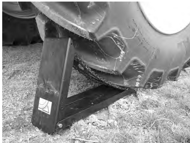
Rys. 86: Ustawianie podkładki klinowej
