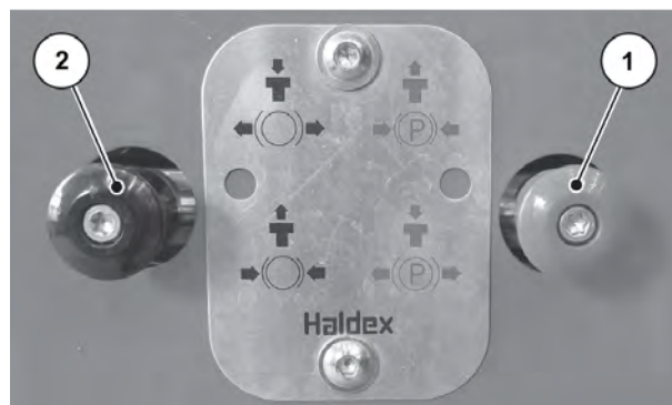
Rys. 80: Zaciąganie ręcznego hamulca postojowego
