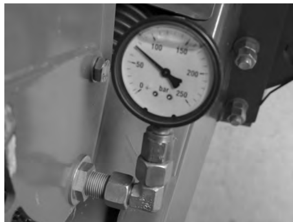
Rys. 122: Manometr na dławiku kablowym nad dyszlem
