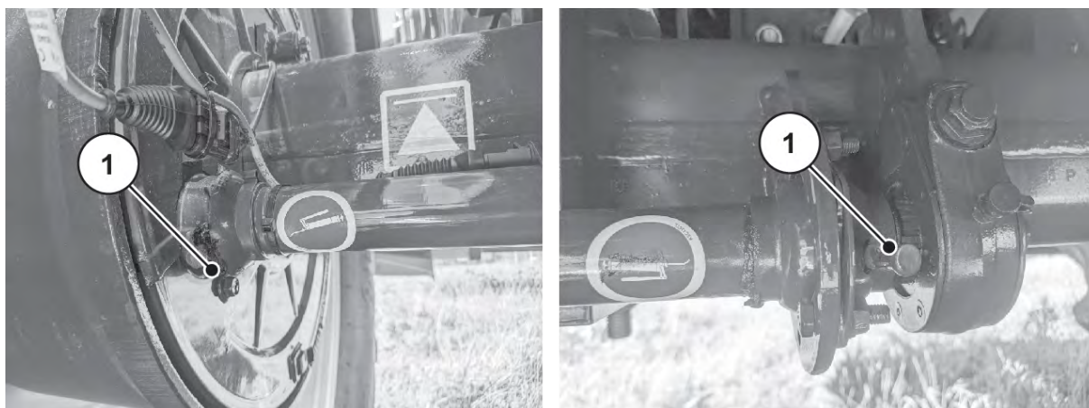
Rys. 99: Łożyskowanie wałka hamulcowego osi sztywnej
