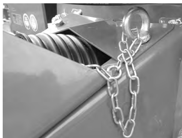
Rys. 25: Mocowanie łańcucha przegubowego
