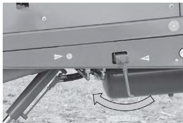
Rys. 84: Zaciąganie ręcznego hamulca postojowego
