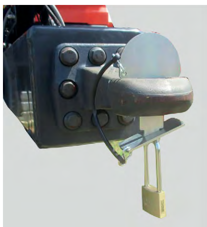
Rys. 12: Zabezpieczenie przed nieuprawnionym użytkowaniem zaczepu holowniczego
