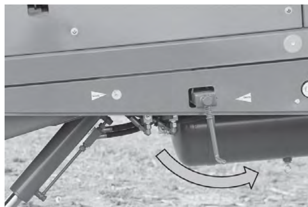
Rys. 34: Zwalnianie ręcznego hamulca postojowego
