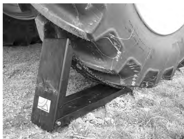
Rys. 82: Ustawianie podkładki klinowej
