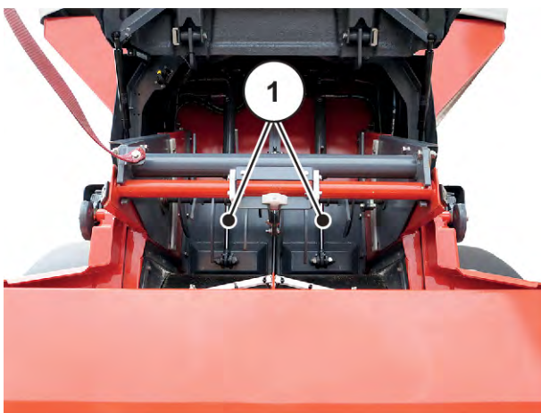
Rys. 52: Zasuwa wstępnego dozowania w położeniu zamkniętym
