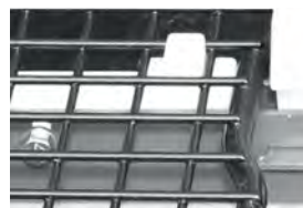
Rys. 42: Montaż sita zasypowego
