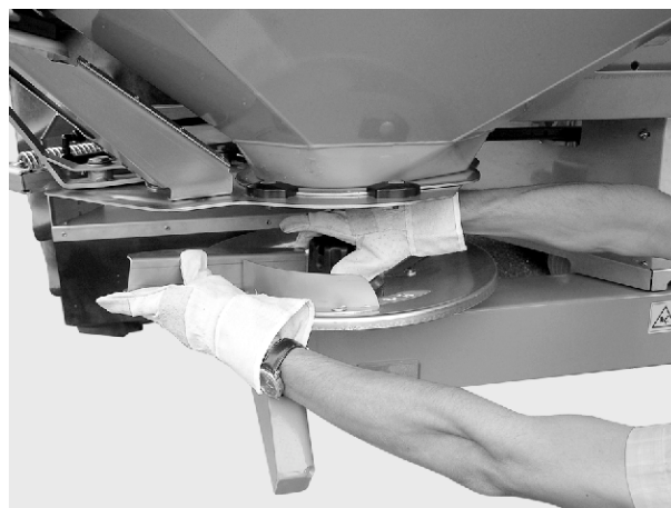
Rys. 69: Odkręcanie nakrętki kołpakowej
