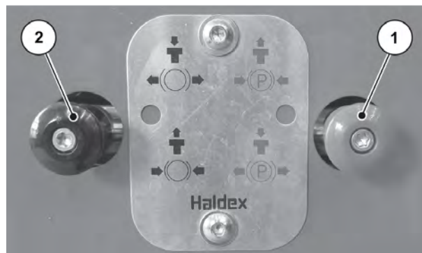
Rys. 33: Zwalnianie hamulca postojowego
