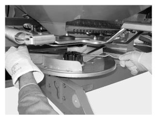
Fig. 68: Loosen the cap nut
