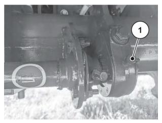
Fig. 101: Rigid axle slack adjuster
