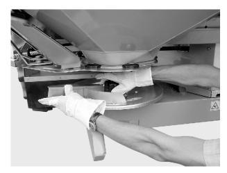
Fig. 69: Unscrew the cap nut
