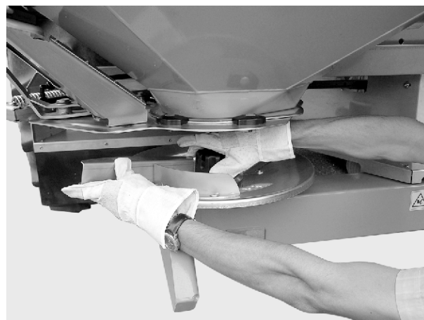
Sl. 69: Odvrtnje zaobljene slijepne matice
