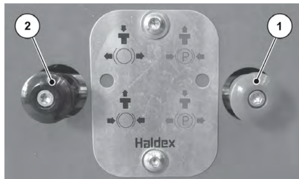
Sl. 33: Otpuštanje parkirne kočnice
