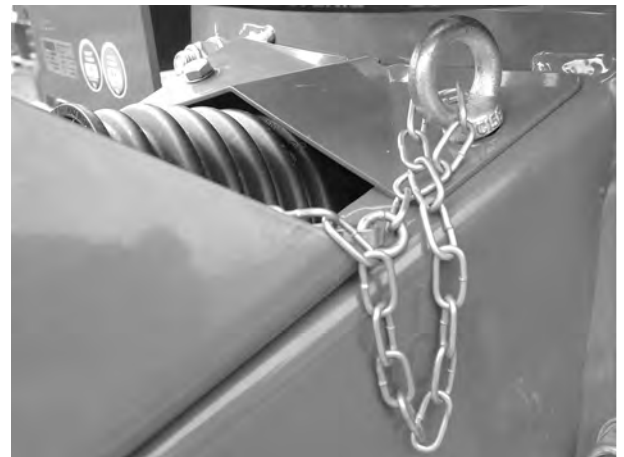
Sl. 25: Pričvršćivanje zadržnog lanca
