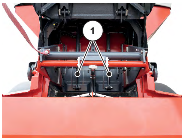
Sl. 52: Klizač za predoziranje u zatvorenom položaju
