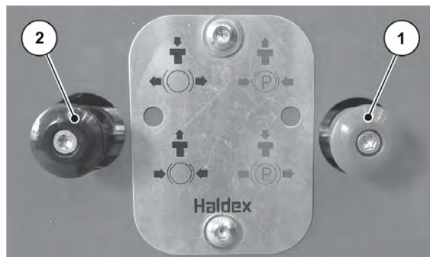
Sl. 80: Ručno povlačenje parkirne kočnice
