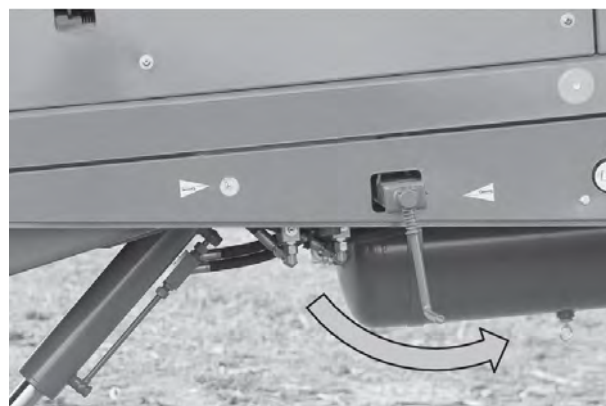
Sl. 34: Ručno otpuštanje parkirne kočnice
