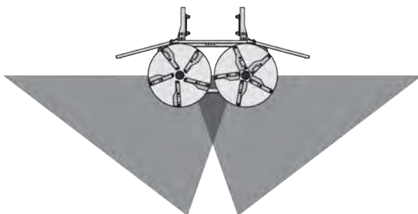
Sl. 75: Normalna raspodjela gnojiva, točka za dodavanje materijala u neutralnom položaju
