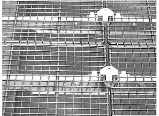
Abb. 44: Einfüllsieb im Behälter
