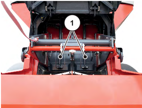
Abb. 52: Vordosierschieber in geschlossener Stellung
