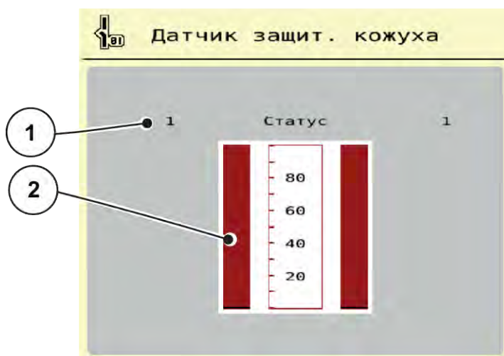
Рис. 29: Тест/диагностика; пример: Датчик защит. кожуха
