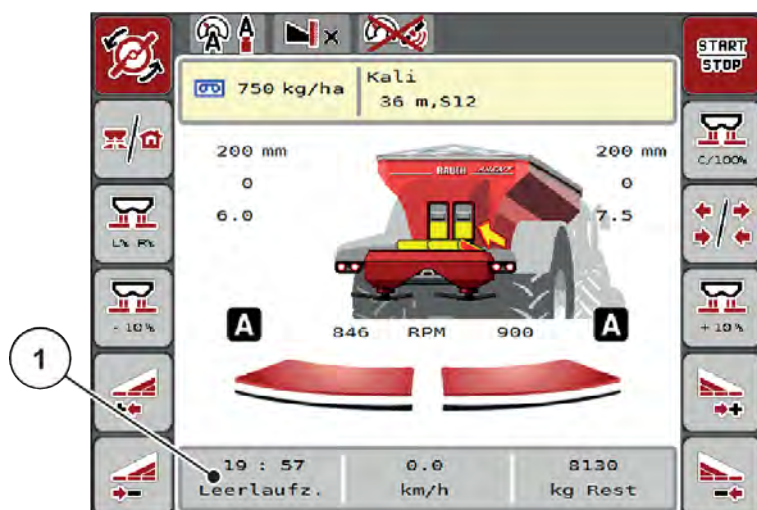
Рис. 47: Индикация измерения холостого хода на рабочем экране
