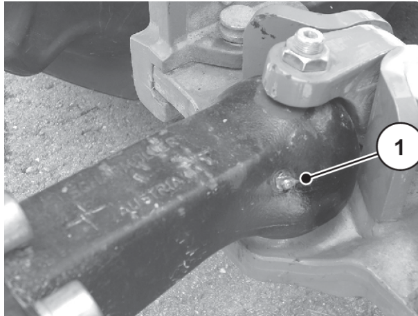
Fig. 120: Cuplaj cu cap sferic
