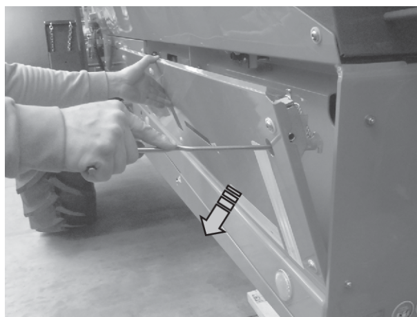
Fig. 84: Rabatați acoperitoarea laterală
