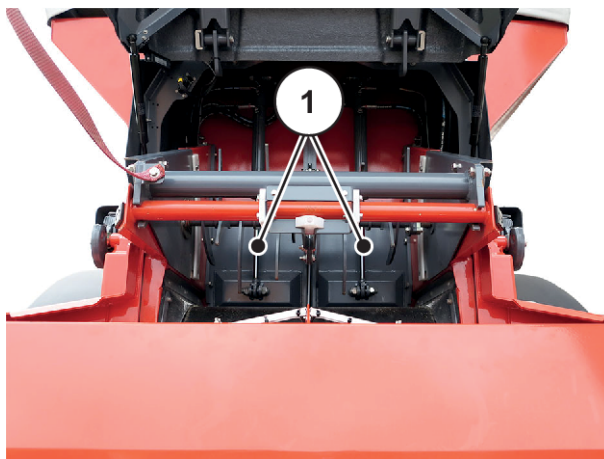
Fig. 51: Glisor pre-dozare în poziție închisă
