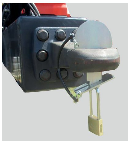
Fig. 7: Siguranță împotriva utilizării neautorizate a dispozitivelor de remorcare
