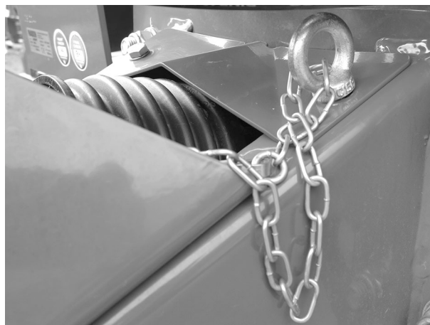
Fig. 24: Fixați lanțul de susținere
