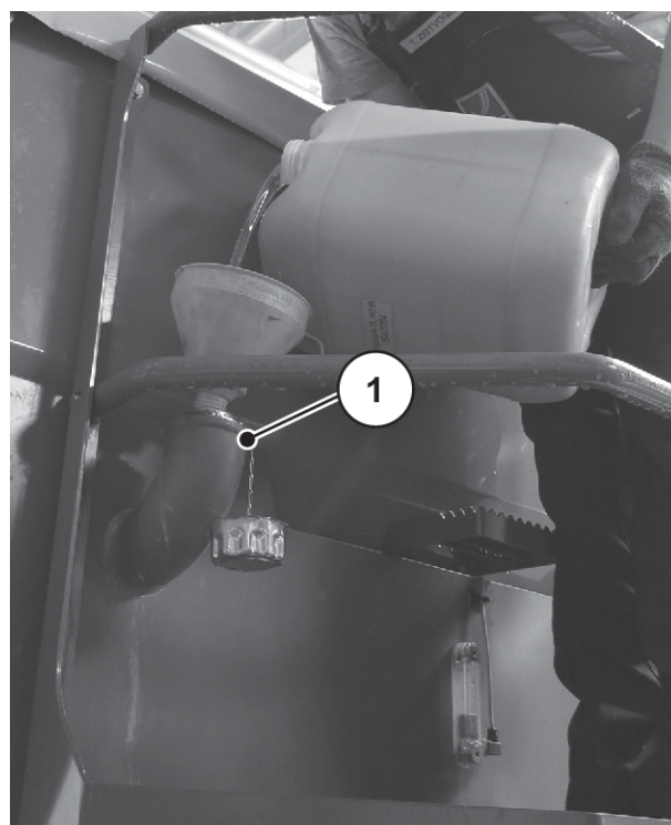
Fig. 94: Umpleți cu ulei
