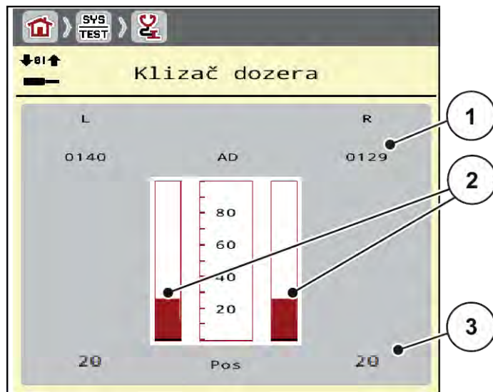
Sl. 31: Test/Dijagnoza; Primer: Zasun dozera
