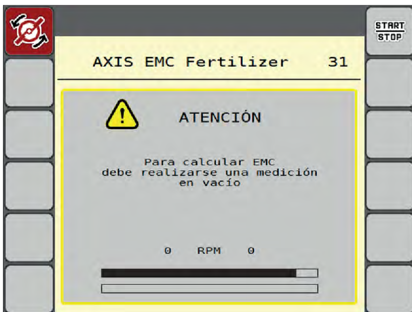
Ilust. 46: Indicador de alarma de medición de marcha en vacío
