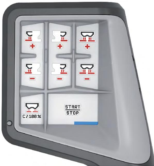
Abb. 41: Tastenbelegung Ebene 3
