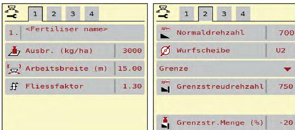
Abb. 18: Menü Dünger Einstellungen, Kalkbetrieb, Reiter 1 und 2
