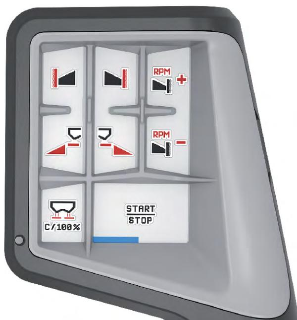
Abb. 40: Tastenbelegung Ebene 2
