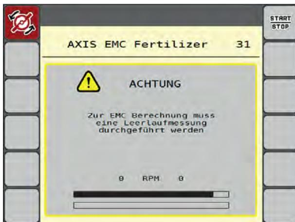
Abb. 46: Alarmanzeige Leerlaufmessung
