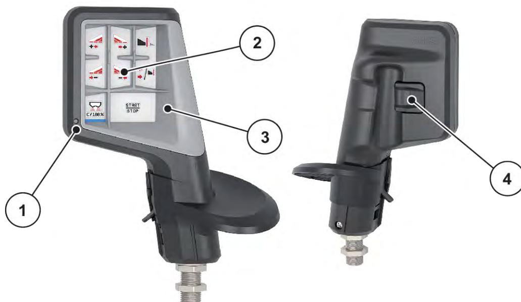
Abb. 37: CCI A3 Joystick, Vorder- und Rückseite
