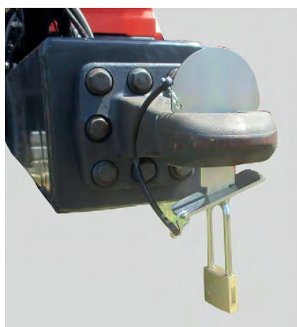
Рис. 10: Захист тягово-зчіпних пристроїв від несанкціонованого використання
