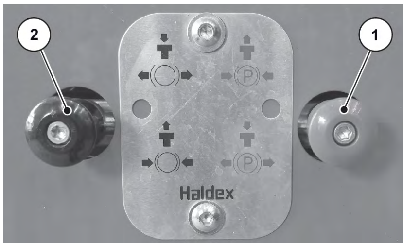
Afb. 53: Handmatige parkeerrem aantrekken
