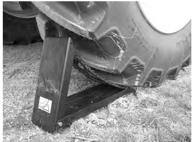
Obr. 55: Umístění klínů pod kola
