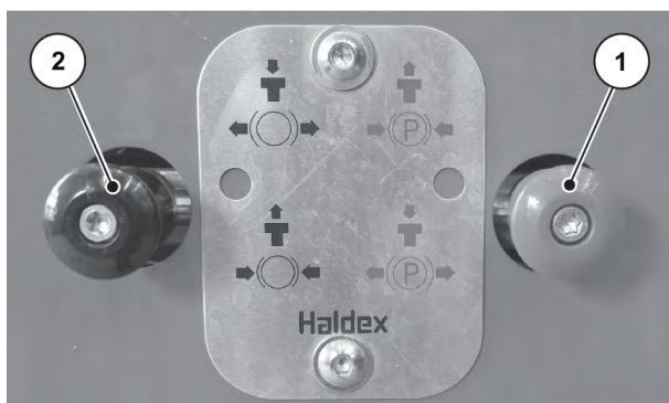
Obr. 43: Odbrzdní parkovací brzdy
