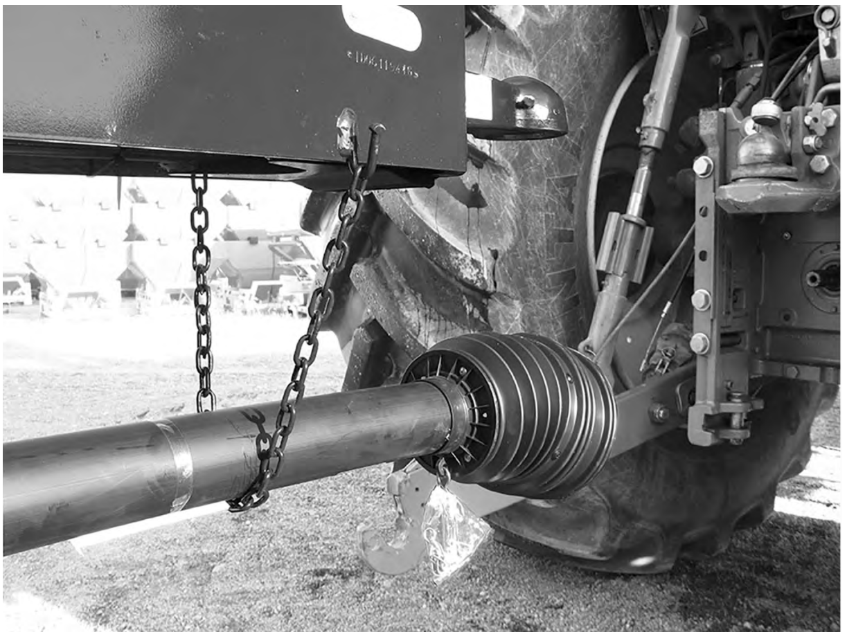
Obr. 24: Uložení kloubového hřídele
