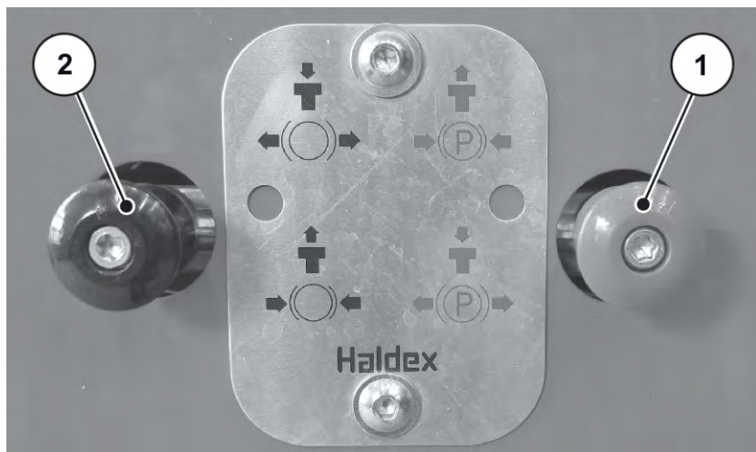
Obr. 53: Ruční zatažení parkovací brzdy
