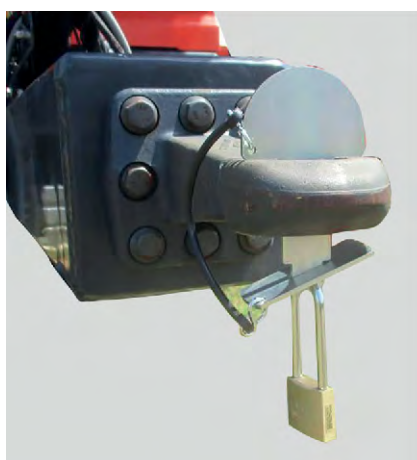
Obr. 10: Pojistka proti neoprávněnému použití tažných zařízení
