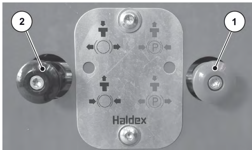
Fig. 53: Serrage du frein de stationnement manuel
