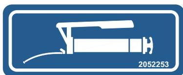
**Figure 10.38** :Symbole pour point de lubrification
