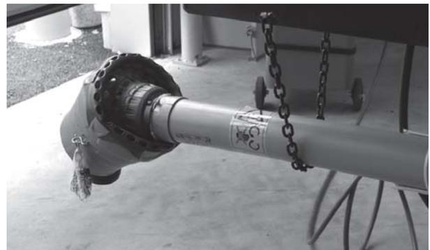
Figure 6.5 : Support de l'arbre de transmission
