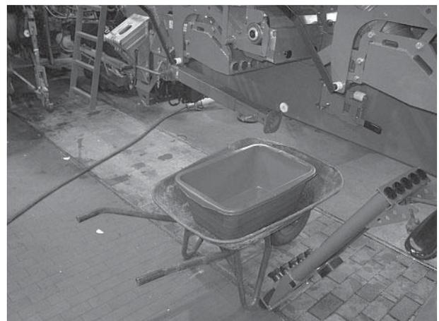
Figure 7.6 : Bac collecteur d'engrais en dessous du dispositif de dosage
