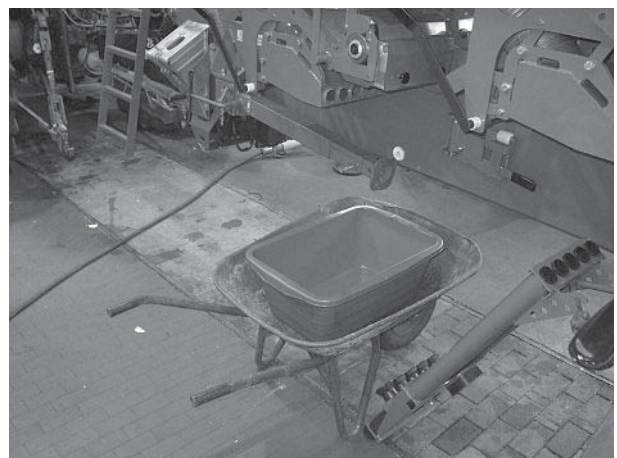
Рисунок 7.6: Приемная емкость для удобрений под дозирующим устройством
