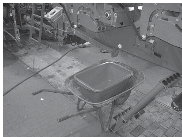
Obrázek 7.6: Zachycovací nádrž na hnojivo pod dávkovacím zařízením
