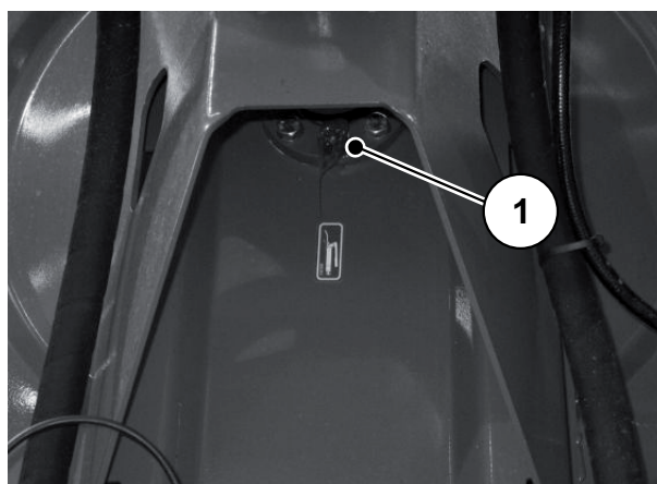
Obrázek 10.39: Přírubové ložisko pohonu dmýchadla
