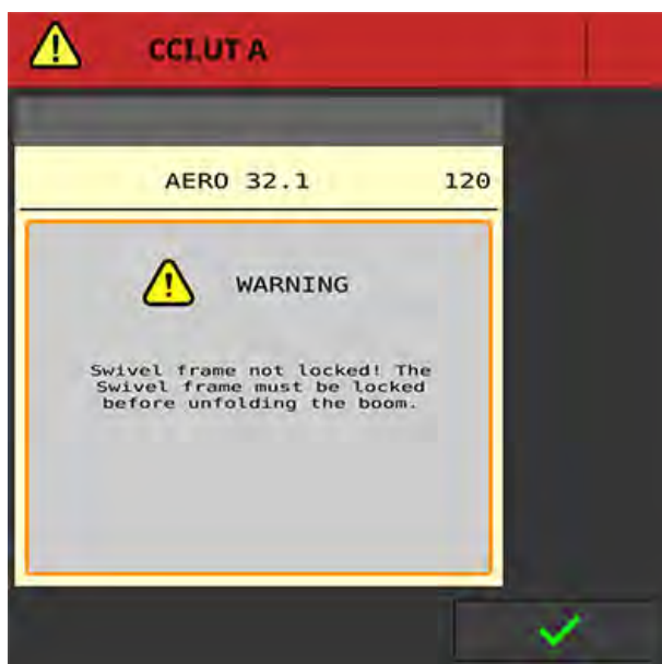
Obr. 12: Alarmové hlásenie týkajúce sa zaistenia otáčavých rámov
