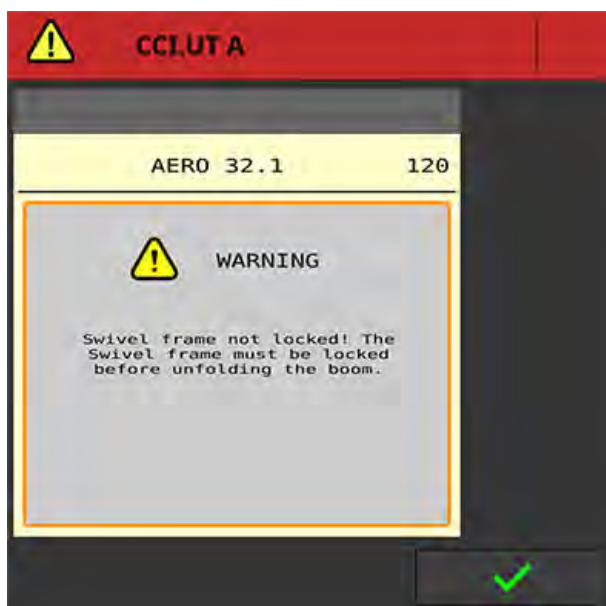
Rys. 12: Komunikat alarmowy dot. blokady ramy obrotowej
