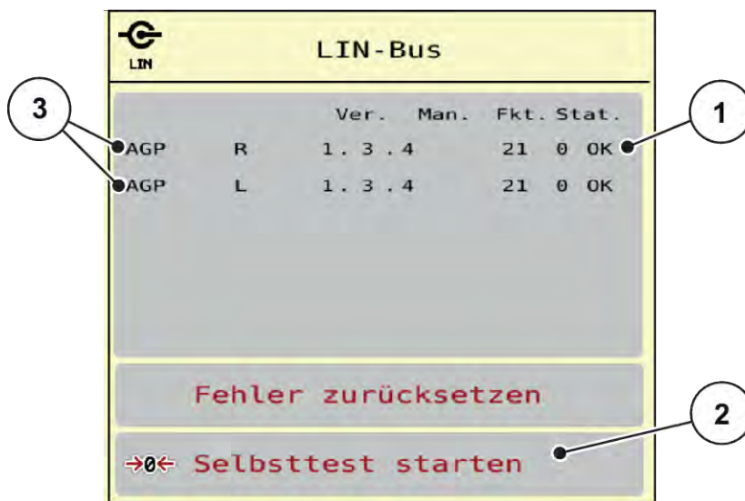
Abb. 20: System/Test; Beispiel: Test/Diagnose
