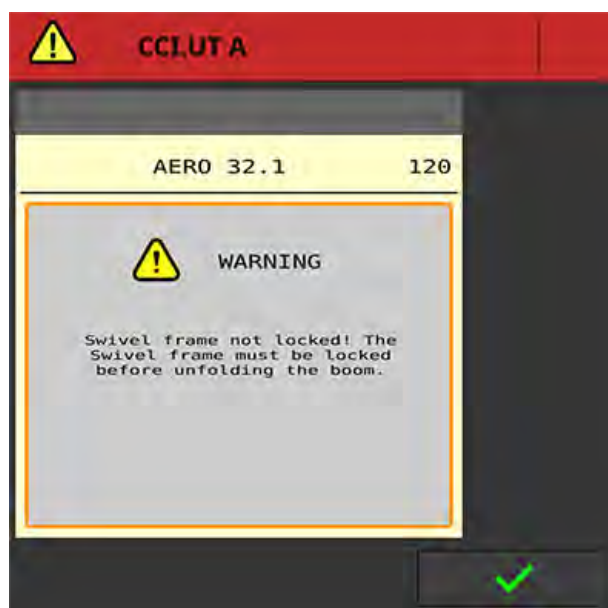
Sl. 13: Alarm na poruka blokade zakretnih okvira
