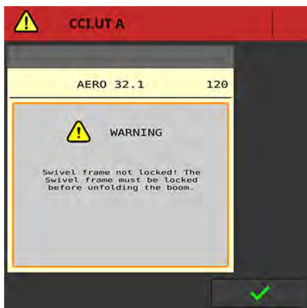
Obr. 13: Výstražné hlášení uzamknutí otočných rámu
