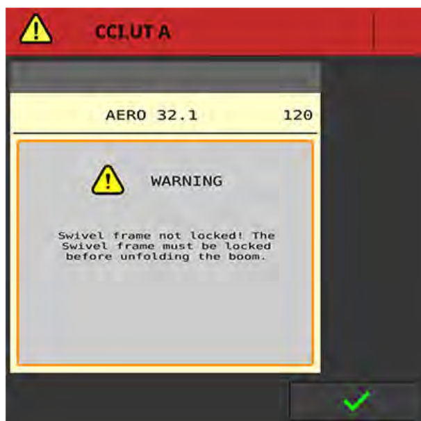
Fig. 13: Mesaj de alarmă blocarea cadrului pivotant
