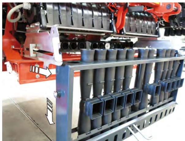
Sl. 53: Spuštanje kasete za ubrizgavanje
