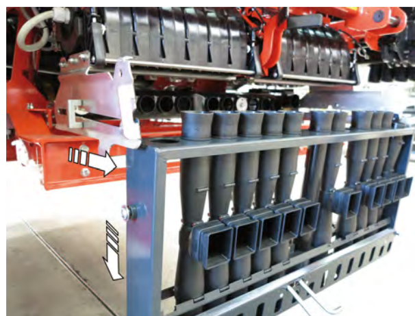
Sl. 34: Spuštanje kasete za ubrizgavanje
