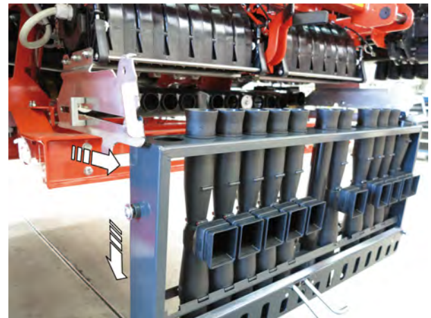
Ábr. 53: Injektorkazetta leengedése
