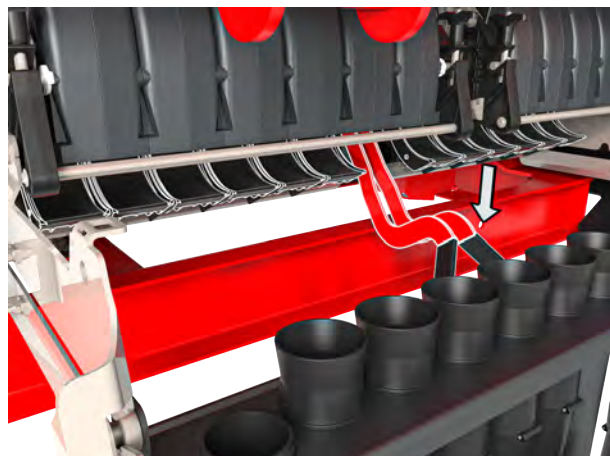
Ábr. 54: Az adagolóteknőn lévő reteszelés nyitása
