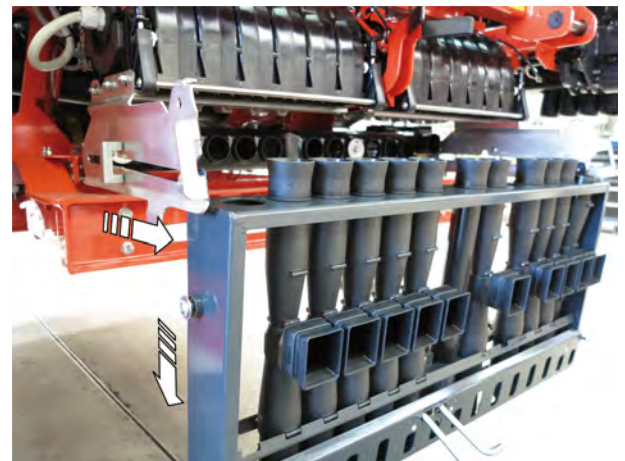
Ábr. 34: Injektorkazetta leengedése
