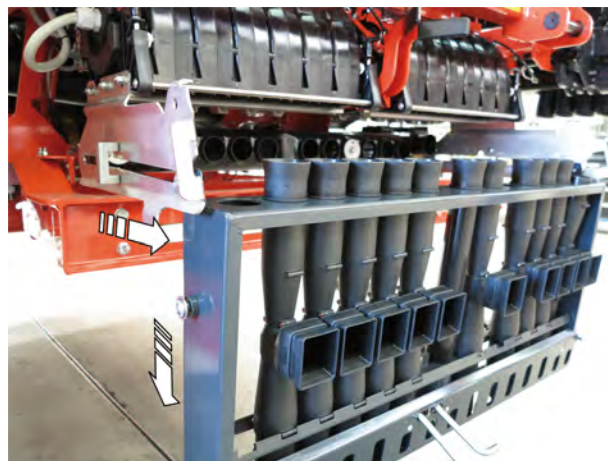
Obr. 53: Spuštění kazety injektoru
