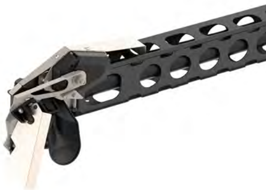
Obr. 21: Funkce hraničního rozmetání je aktivní
