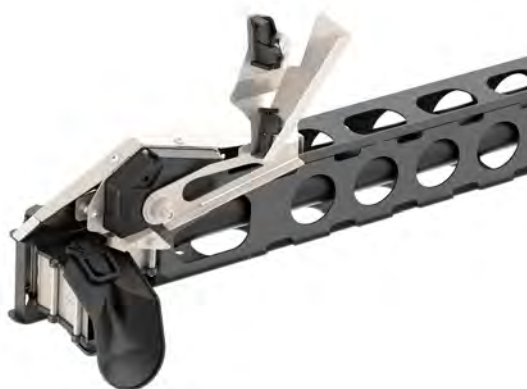
Obr. 20: Funkce hraničního rozmetání je neaktivní
