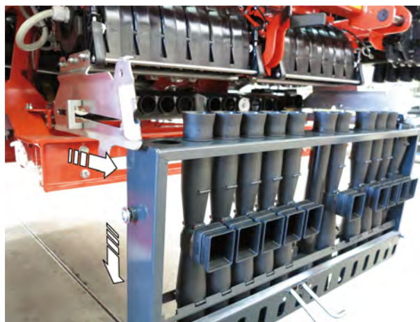
Obr. 34: Spuštění kazety injektoru
