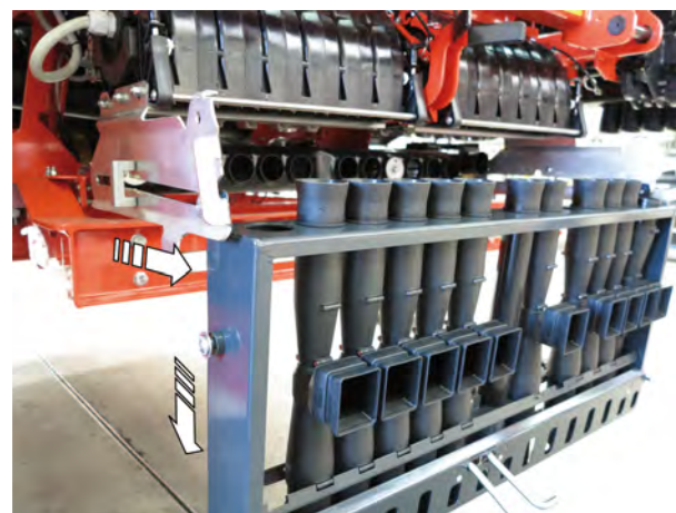
Rys. 53: Opuszczanie kasety iniektora
