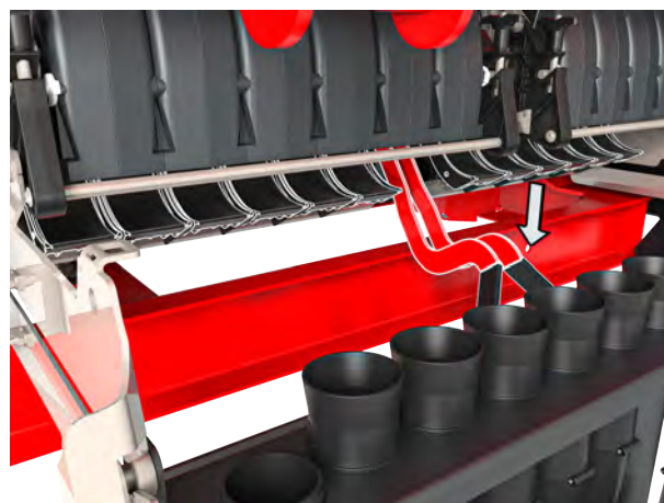
Rys. 37: Odblokować koryto dozującego
