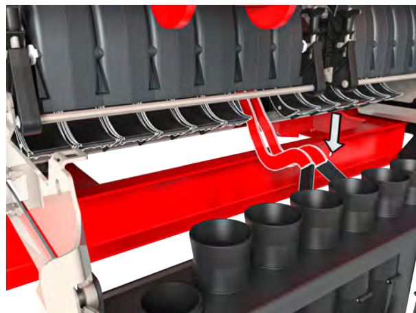
Rys. 54: Otwieranie blokady koryta dozującego
