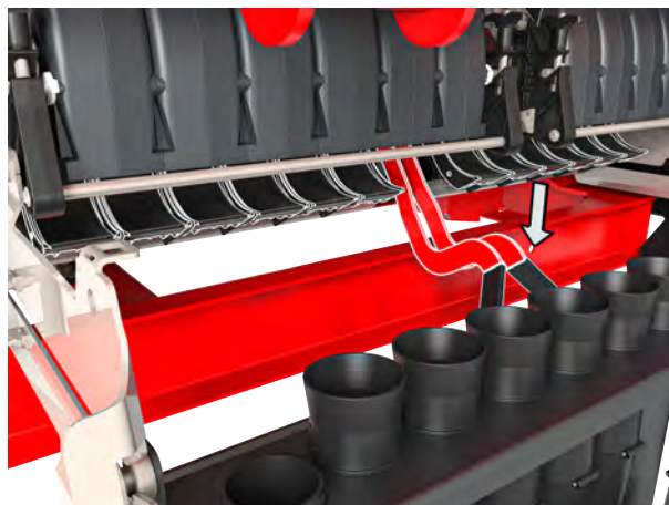
Att. 54: Dozēšanas tekņu bloķētāju atbrīvošana
