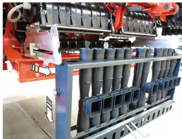
Att. 34: Inžektora kasetes iztukšošana
