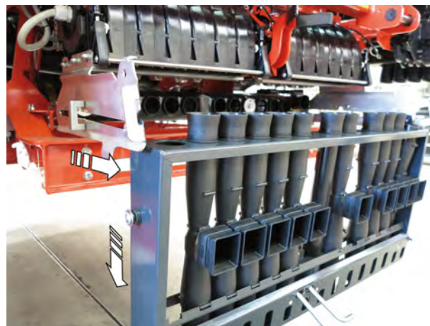
Att. 53: Inžektora kasetes iztukšošana
