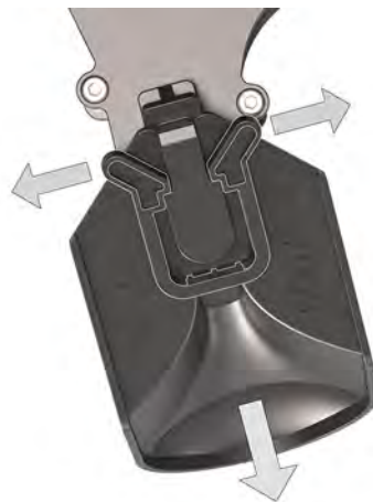
Att. 48: Deflektora plāksnes izvilkšana
