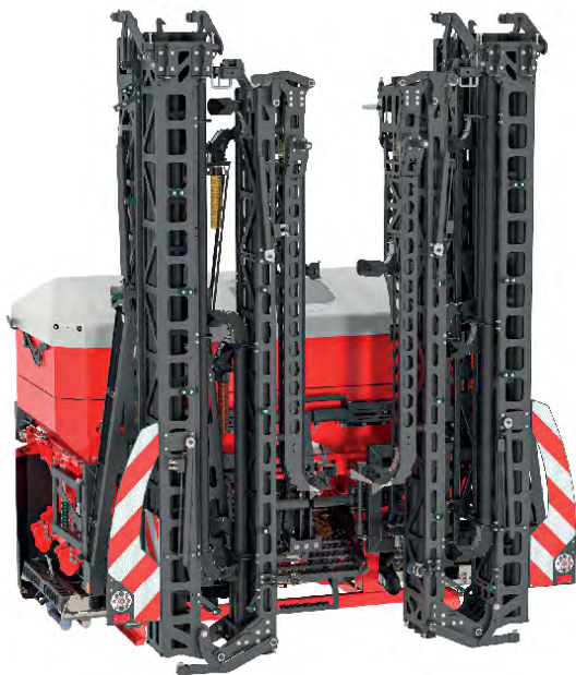
Fig. 49: Maskin i transportposisjon
