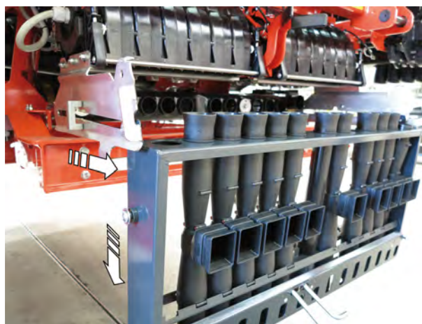
Obr. 51: Spuštění kazety injektoru
