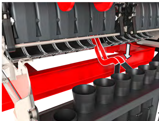
Obr. 35: Odjištění dávkovacího žlabu
