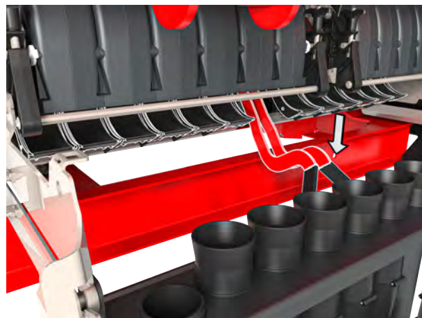
Obr. 52: Otevření zámku dávkovacího žlabu
