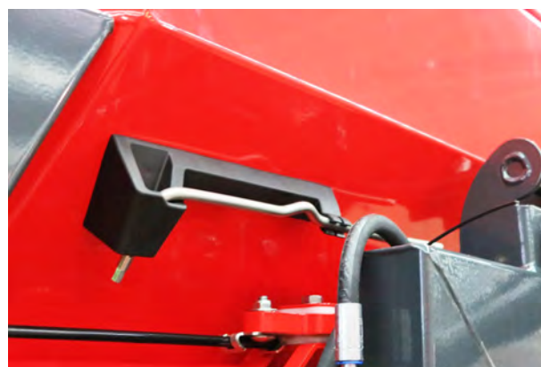
Obr. 8: Poloha nastavovací páky
