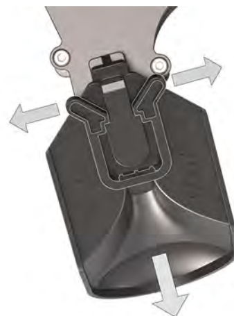
Obr. 46: Vytažení odrazného štítu
