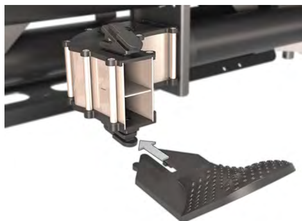
Obr. 47: Přesunutí odrazného štítu
