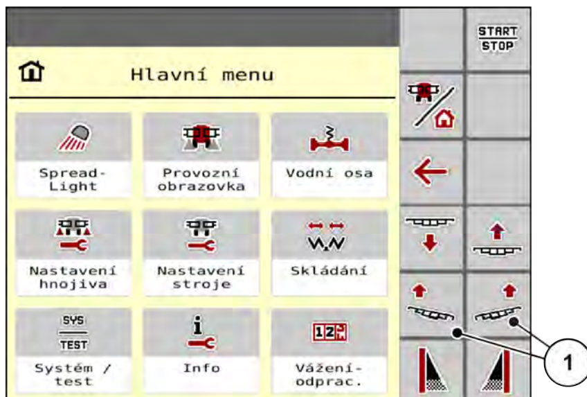
Obr. 44: Funkční tlačítka nastavení sklonu výložníku
