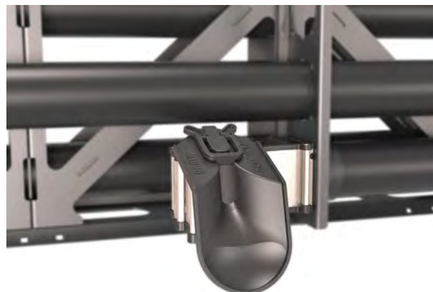
Obr. 45: Odrazný štít při normálním hnojení
