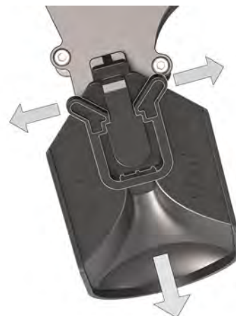
Att. 45: Deflektora plāksnes izvilkšana
