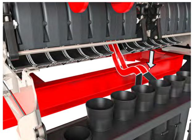
Abb. 51: Verriegelung der Dosierwanne öffnen
