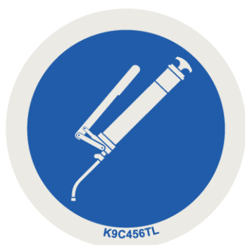
Fig. 47: Autocollant des points de lubrification
