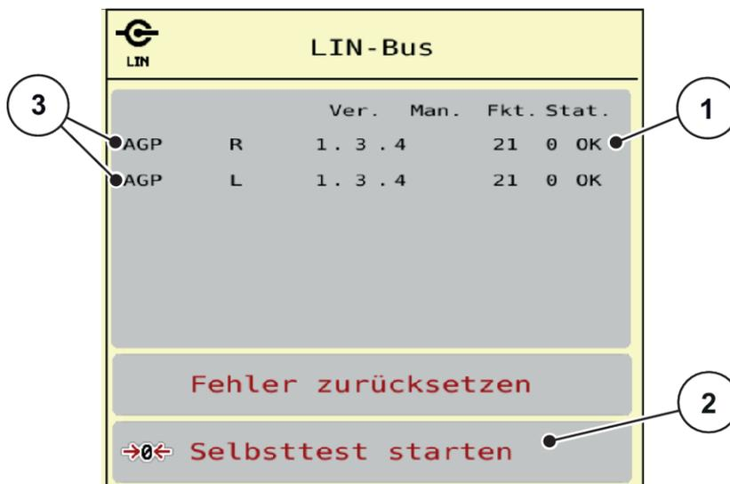
Abb. 21: System/Test; Beispiel: Test/Diagnose
