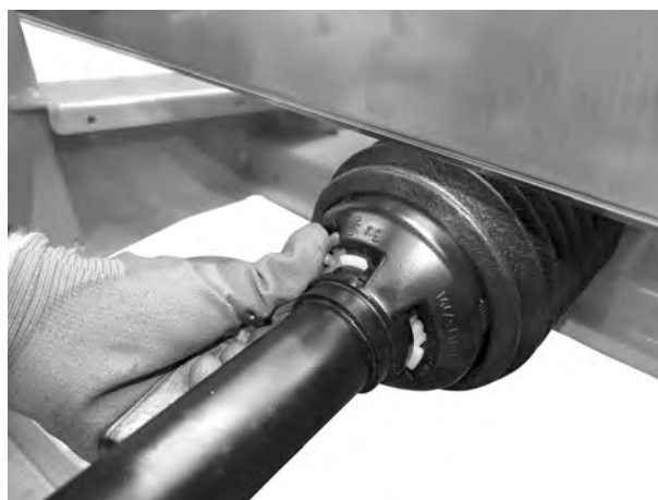
Obr. 19: Zajištění krytu kloubového hřídele
