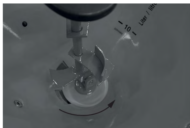
Obr. 23: Míchadlo je namontováno
