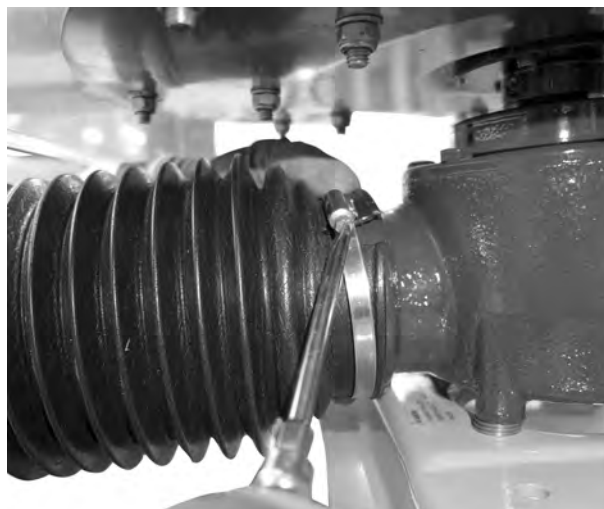
Obr. 18: Montáž krytu kloubového hřídele
