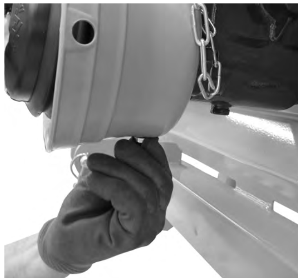
Рис. 9: Вставлення гвинта з шестигранною головою
