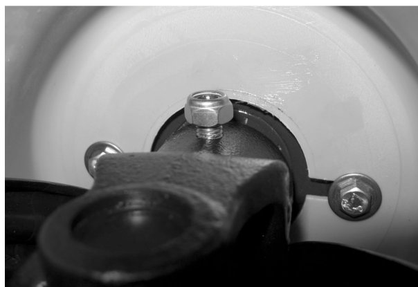
Рис. 10: Затягнення болта з шестигранною головкою
