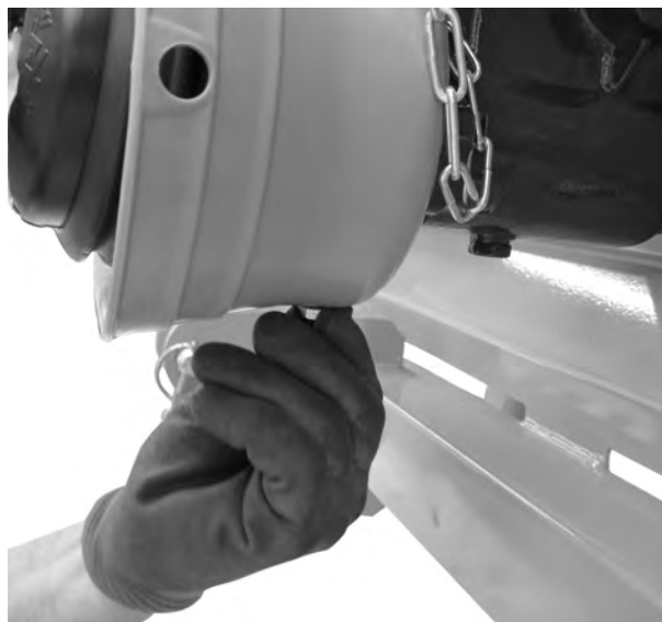
Rys. 9: Wprowadzenie śruby z łbem sześciokątnym
