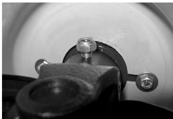
Rys. 10: Dokręcanie śruby z łbem sześciokątnym
