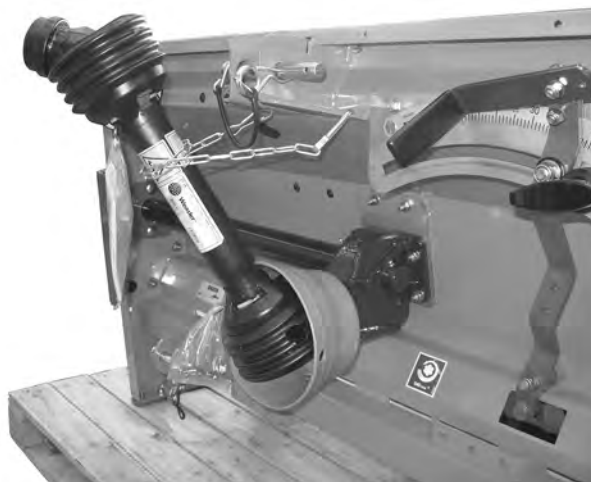
Rys. 11: Zawieszenie wału przegubowego
