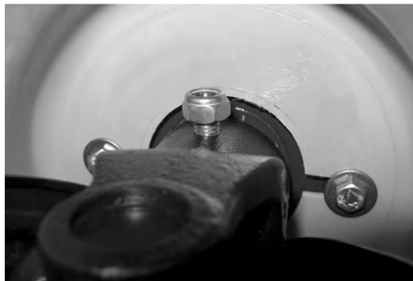
Ábr. 10: Hatlapú csavar meghúzása
