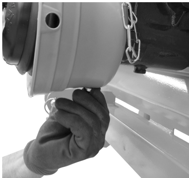
Fig. 9: Introduire la vis à tête hexagonale
