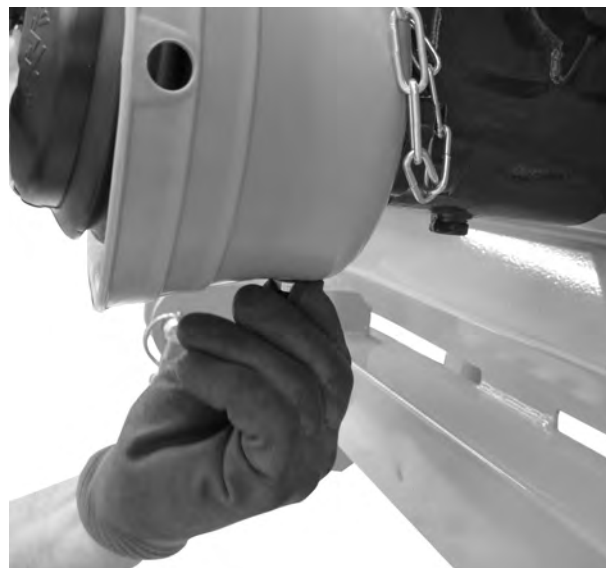
III. 9: Inserire la vite esagonale.
