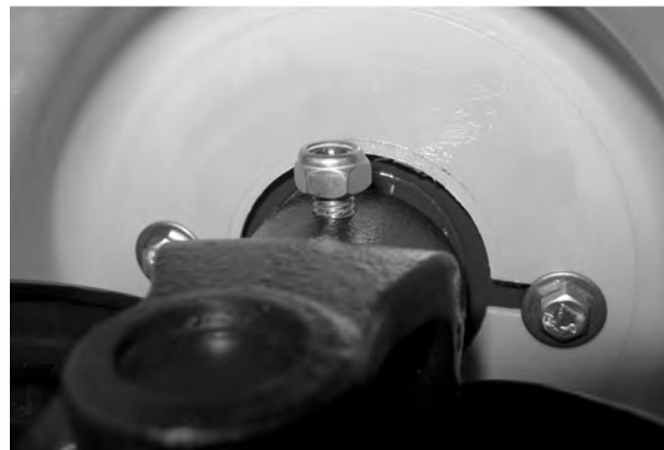
III. 10: Serrare la vite esagonale.
