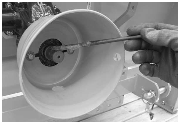
III. 8: Perno del riduttore
