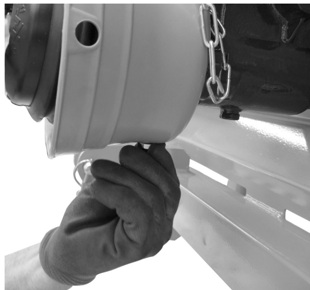
Fig. 9: För in sexkantskruven
