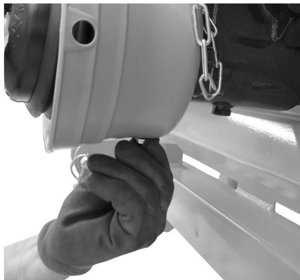
Obr. 9: Montáž šroubu se šestihlannou hlavou
